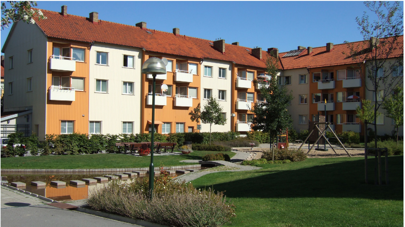
Mynd 8 Dæmi um sýnilegt vatn í blágrænum ofanvatnslausnum við leikvöll í Augustenborg.
