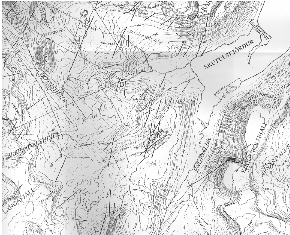
Mynd 2 – Berggangar og misgengi við framkvæmdasvæðið og í nágrenni Skutulsfjarðar. Fjallið Hafrafell er fyrir miðri mynd en nyrsti hluti þess heitir Kubbi. Þykku svörtu línurnar eru berggangar en grönnu svörtu línurnar sýna misgengi (mynd Ágúst Guðmundsson 1989).
