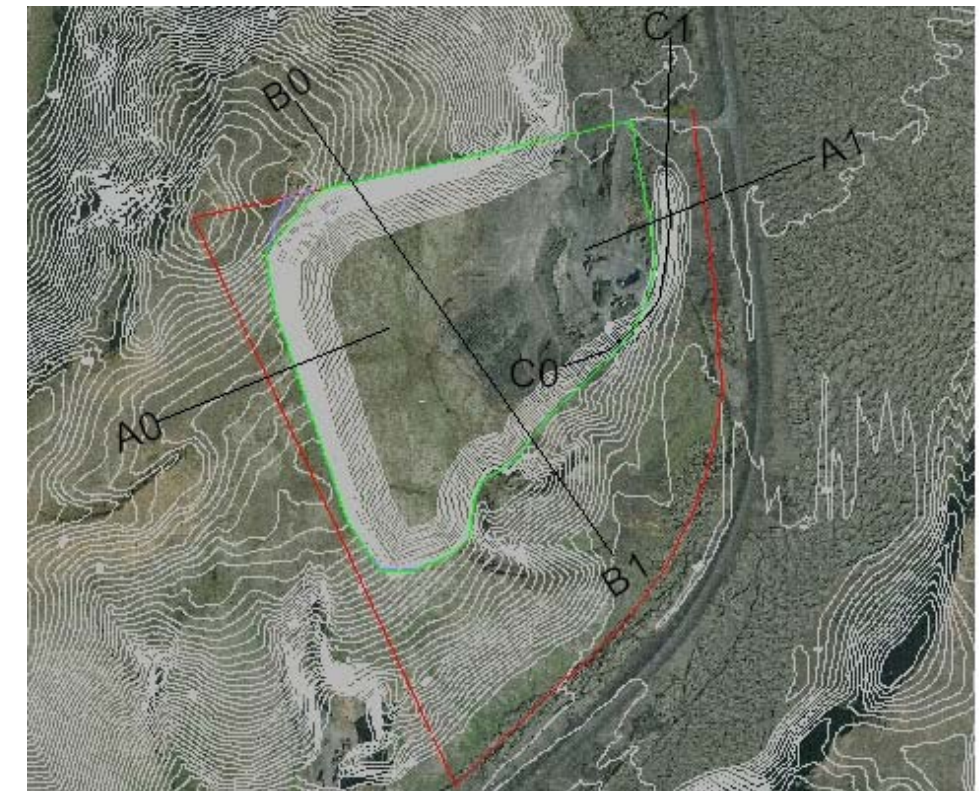
Mynd 2.5 Yfirlitsmynd af námunni sem sýnir staðsetningu þversniða. Rauð lína sýnir landamörk, græn lína sýnir útmörk efnistökkunnar. Hæðalínur sýna hæð í landi að efnistöku lokinni.
