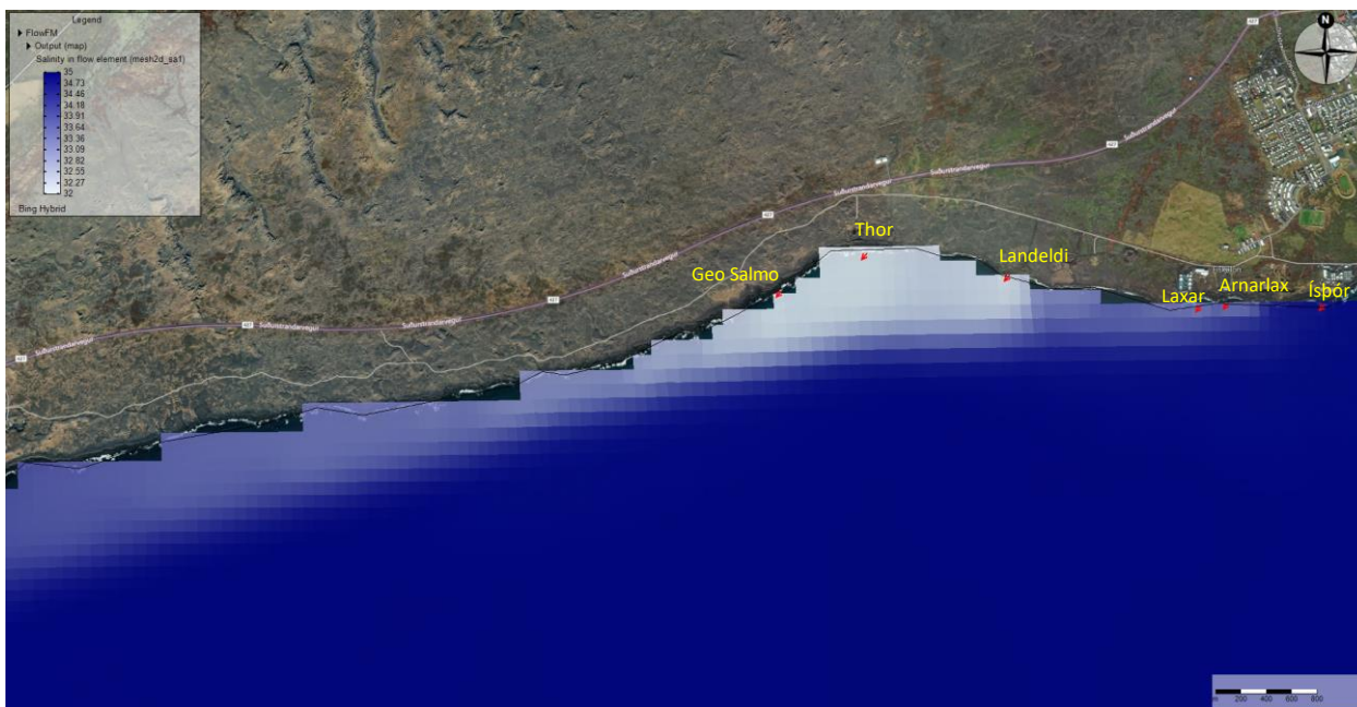
MYND 3.4 Reiknuð seltu breyting. Litaskali er frá hvítu til blátt þar sem hvítur litur sýnir lægstu reiknuðu seltu vegna útrásarinnar en blátt sýnir seltu í viðtakanum. Áfangi 2
