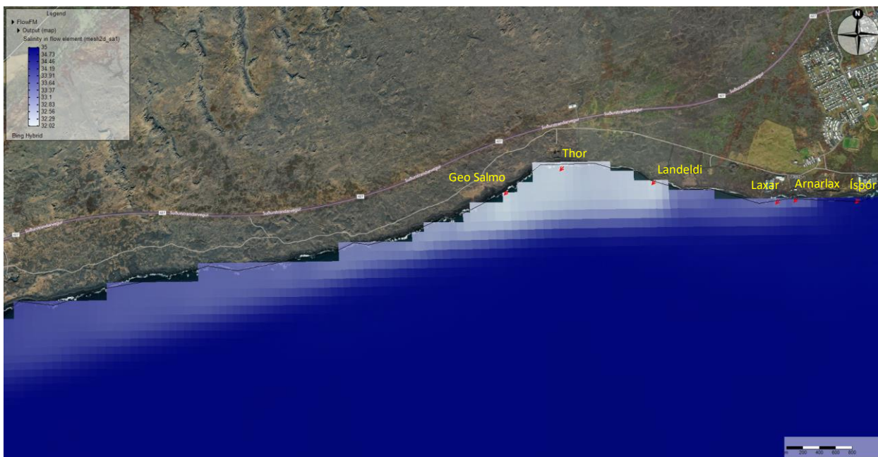
MYND 3.3 Reiknuð seltu breyting. Litaskali er frá hvítu til blátt þar sem hvítur litur sýnir lægstu reiknuðu seltu vegna útrásarinnar en blátt sýnir seltu í viðtakanum. Áfangi 1
