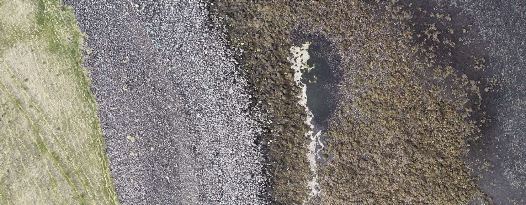
Mynd 5.4: Loftmynd af strönd Þerneyjar þar sem skerspenna mun aukast en líkur á rofi eru ólíklegar vegna þess hvað ströndin er gróf.
