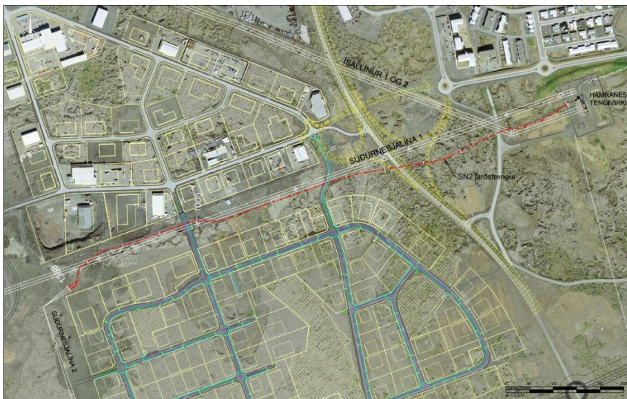
Mynd 6.18 Útfærsla á línu í Hafnarfirði. Lega jarðstrengs er milli Hamraness og Hraunhelli (rautt brotastrik). Við tekur loftlína með stefnu á Hrauntungur (hvít lína).
