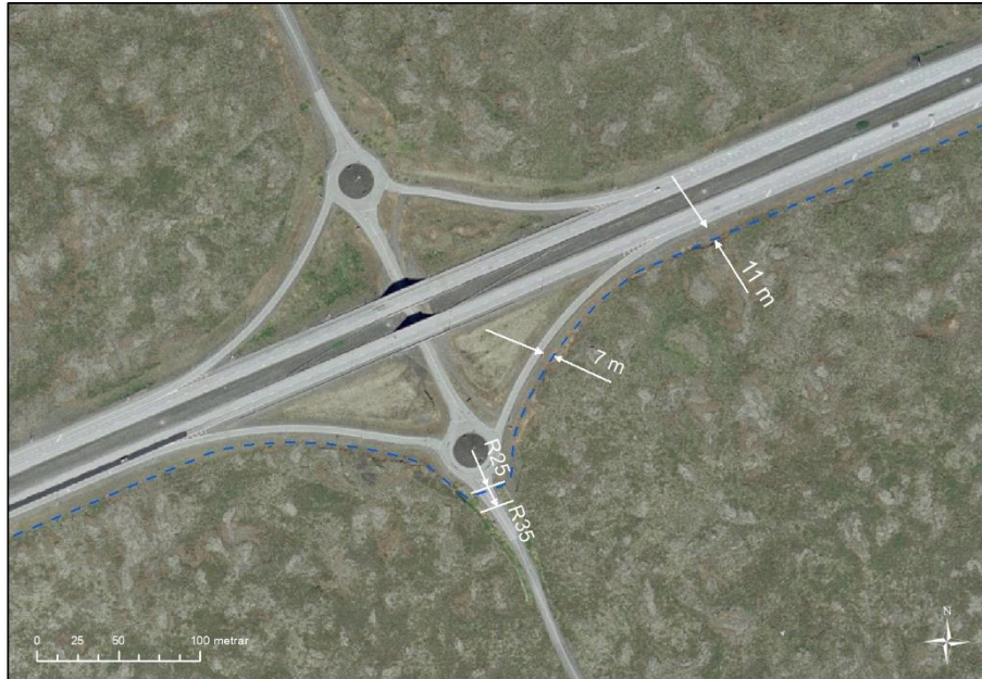
Mynd 6.15 Lega jarðstrengs við gatnamót. Fjarlægð frá kantlínu Reykjanesbrautar er 11 m en 7 m við rampa (að- og fráreinar).
