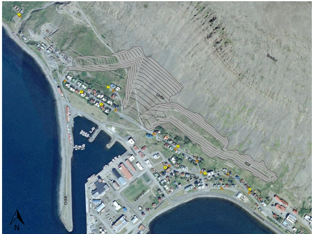
Mynd 5.5 Tillaga að staðsetningu 8 grunnvatnshola. Ein hola verður staðsett utan áhrifsvæðis framkvæmda til samanburðar (Verkís, 2017b).
