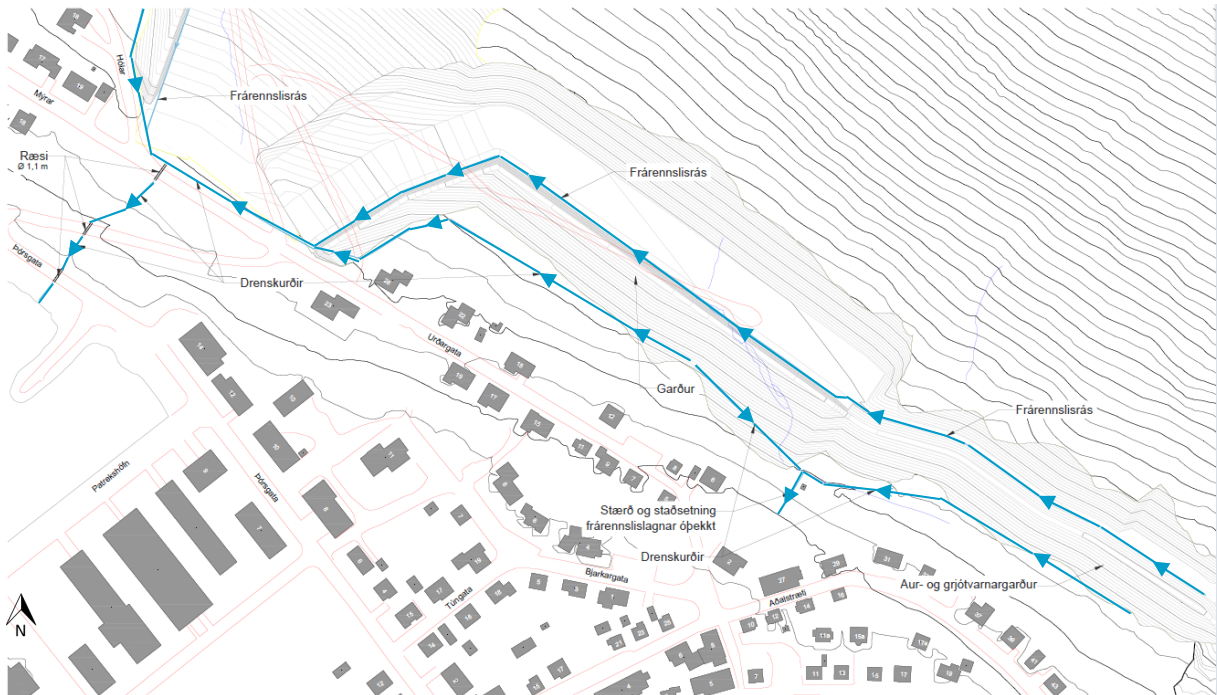
Mynd 5.4 Tillögur Verkíss (2016) um fránrennslíni við Urðargarð. Fránrennisslínur hafa verið skerptar.
