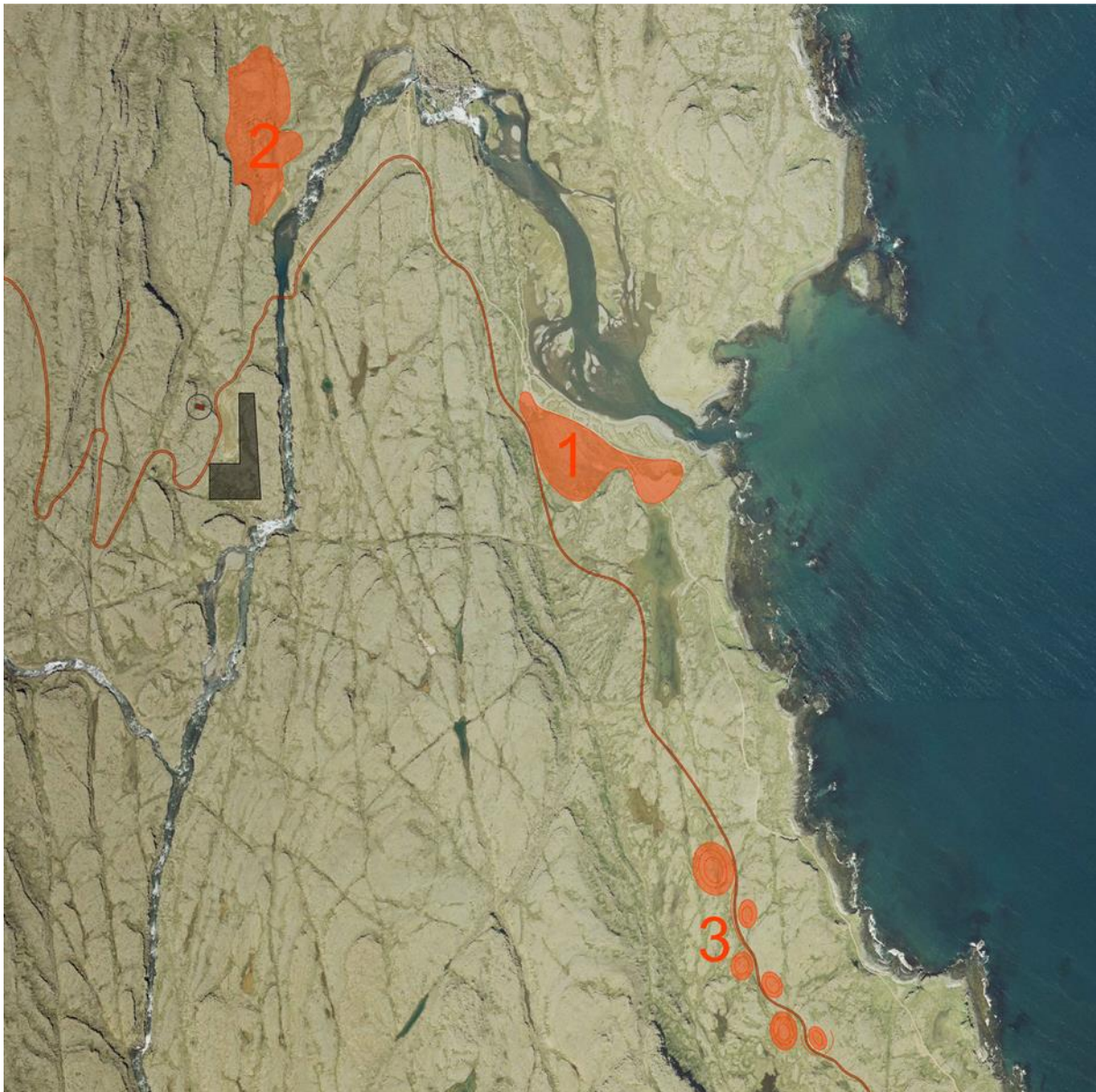
Mynd 3 Fyrirhuguðu efnislosunarsvæði við ós Hvalár (1), norðan við vinnubúðasvæði (2) og við vegstæði við Ófeigsfjörð (3).
