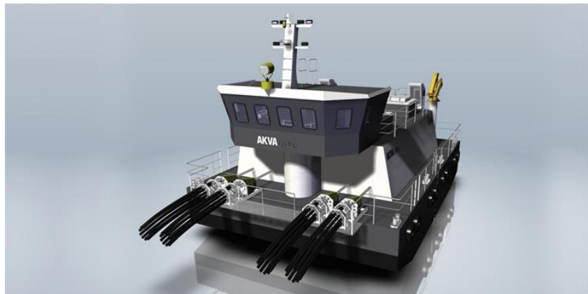
Mynd 2.3.6. Dæmi um fóðurpramma eins og notaðir eru erlendis ( www.akvagroup.com ).
