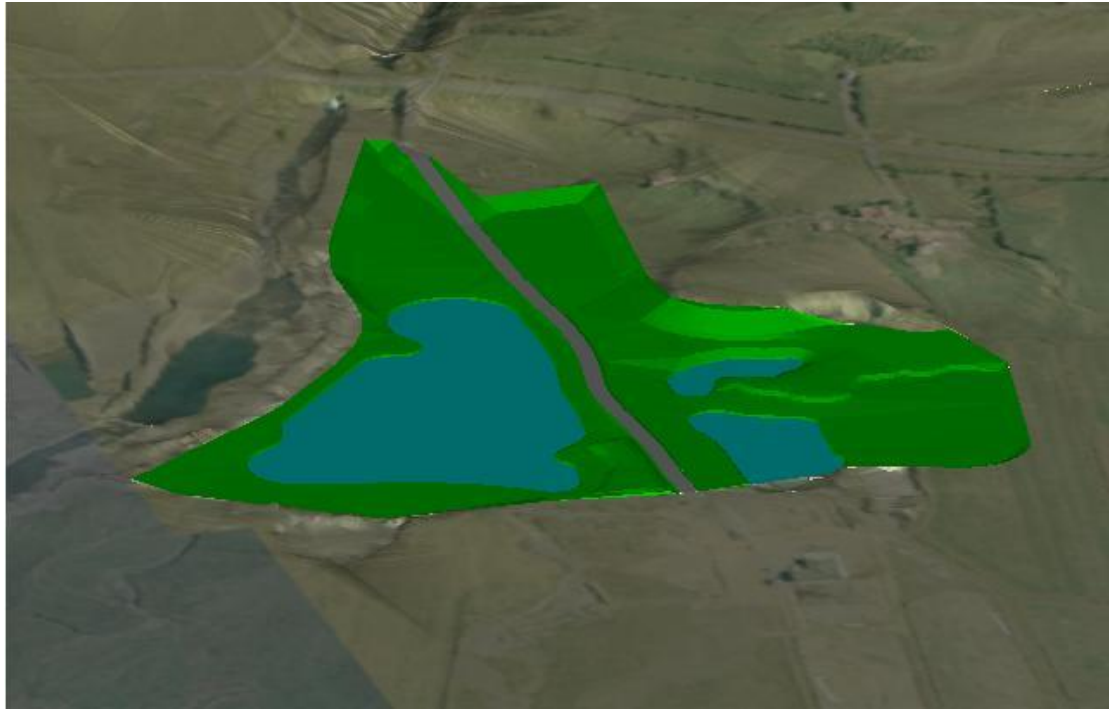
Mynd 4.3.4.7: Fyrirhuguð landmótun felld inn í loftmynd. Grænn litur táknar landyfirborð eftir formun og frágang. Grár borði táknar veg að iðnaðarsvæði. Blár litur táknar vatnsyfirborð.
